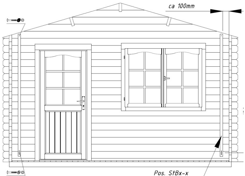
Installatie van de stormankers:
