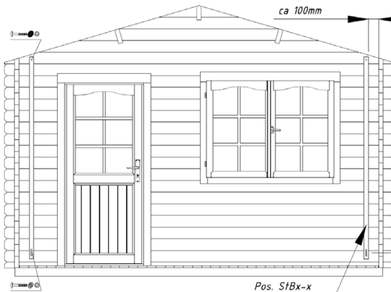
Montage des contreventements:
