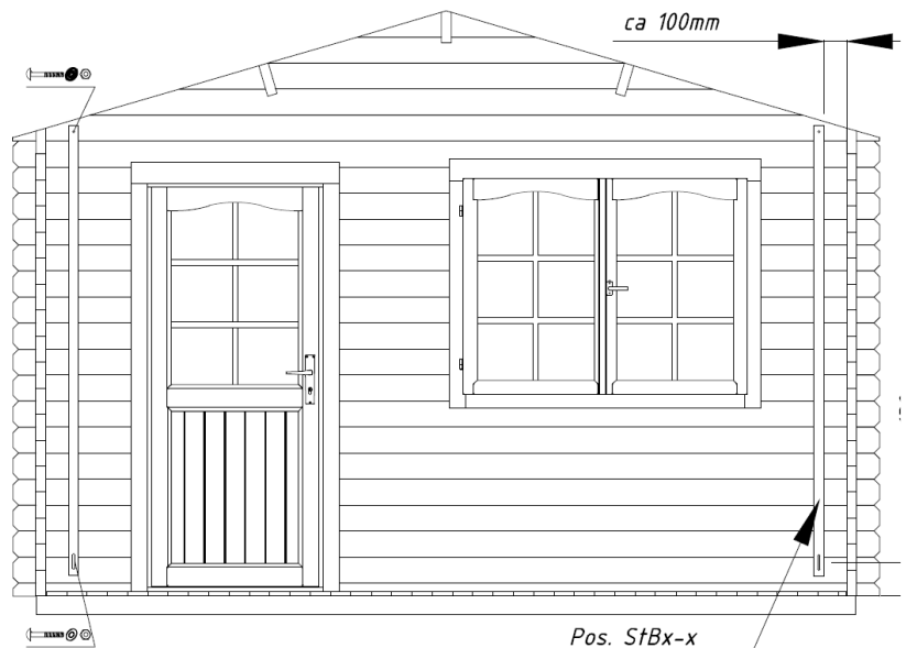
Installatie van de stormankers:
